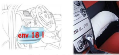
Airbag de genoux situé sous la colonne de direction Citroën C5, Mercedes SLR, Toyota Aveniris...
