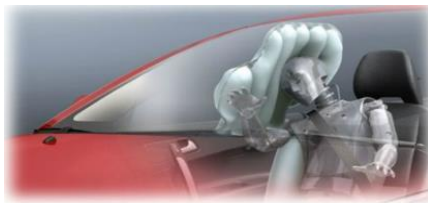
Airbag de tête sur véhicule cabriolet
